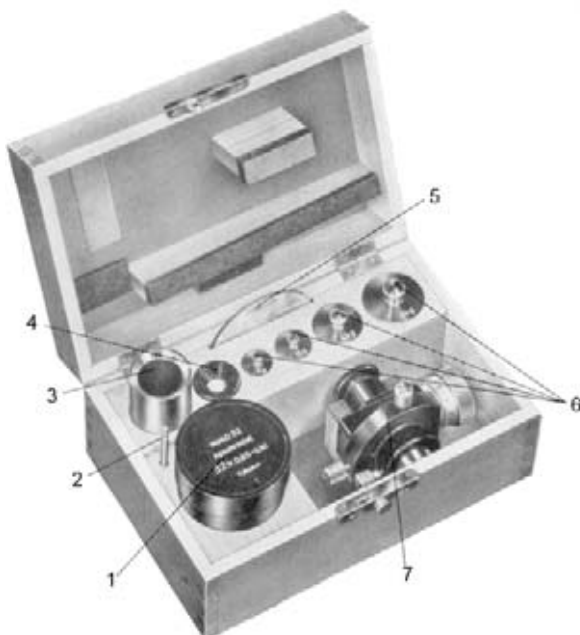
Bild 4 Gesamtausrüstung der Mikrohärte-Prüfeinrichtung D 32 für »Neophot«
