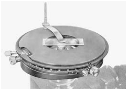
Bild 12 Kleine Probe, an einen Objektträger gekittet und in die Einlegetröge eingehängt
