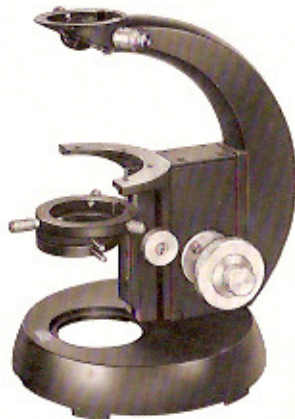
Bild 4 STANDARD-Storiv GFL mit Vergrößerungswechsler 1,6x im Tubuskopf mit Schlittenführung. Die Öffnung im Fuß nimmt entweder den Blendeneinsatz der Einbuleuchte oder einen Spiegelteller mit dem üblichen Beleuchtungsspiegel auf.
