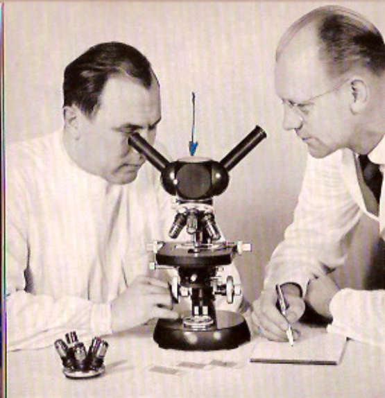
Bild 16: Das Zwischenstück für den Diskussions-tubus ermöglicht den Ausbau des STANDARD-Mikroskops für die gleichzeitige Beobachtung des mikroskopischen Bildes durch 2 Personen, etwa zur Diskussion von Befunden oder bei Prüfungen. Es können dann 2 monokulare oder binokulare Tuben angesetzt werden.
