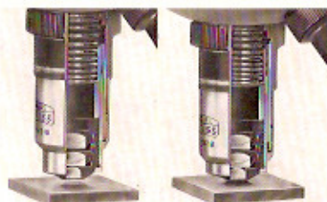
Bild 18: Die stärkeren Objektive sind in Federfassung gelagert. Diese geben beim Aufstoßen des Objektivs auf das Deckglas nach und bieten dadurch völligen Schutz für Präparat und Objektivfrontlinse.
