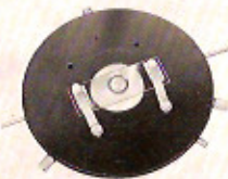
Bild 7: Runder, dreh- und zentrierbarer Gleittisch (Tisch 54)
