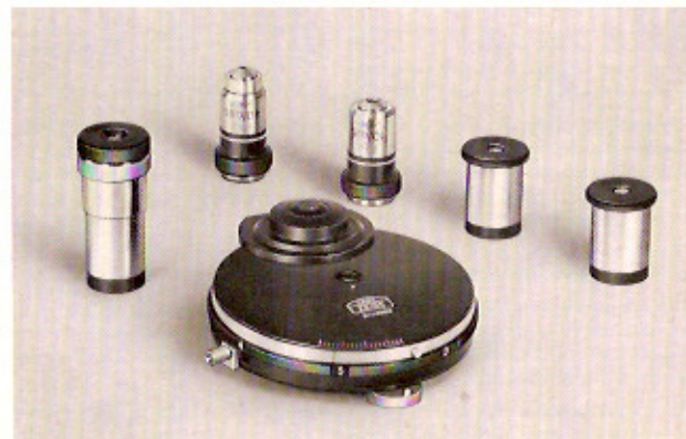
Bild 19: Hellfeld-Phasenkontrast-Deckelfeld-Kondensator III Z mit Hilfsmikroskop (links), Phasenkontrastobjektiven und C-Okularen.
