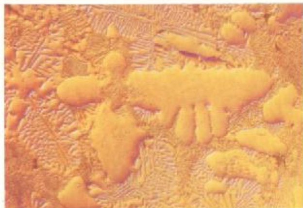
Schnellstahl, stark überhitzt gehärtet. EPIPLAN 80/0,95 Pol, Aufsetzkamera C 912 CS. Abbildungsmaßstab 500:1 (1000:1) Agfachrome 50 L. Präparat: Werkstofflabor, CARL ZEISS, Oberkochen. Aufnahme: G. Wilpert, Oberkochen.
