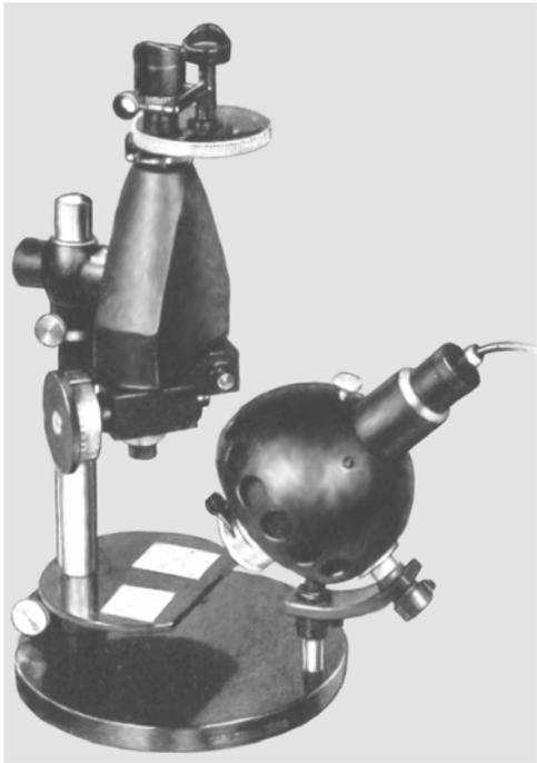
Bild 3. Pulfrich-Photometer für Schwärzungsmessungen an photographischen Papieren
